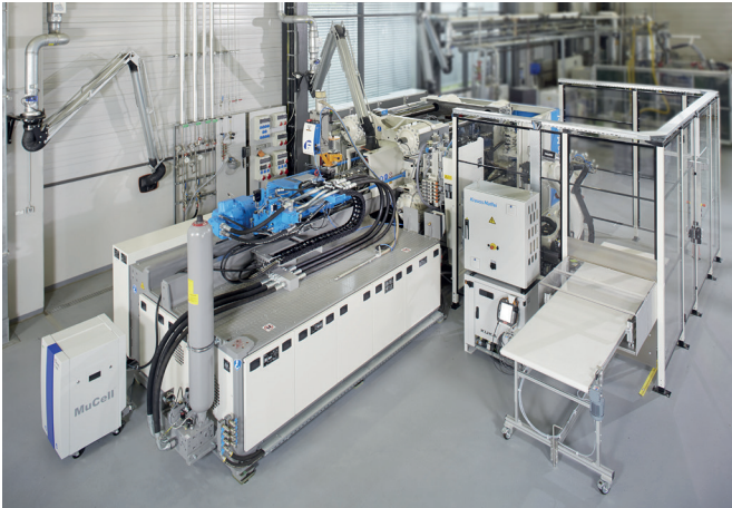
Spritzgießfertigungszelle für das Hybrid-Molding-Verfahren – geeignet für Hochtemperaturthermoplaste
