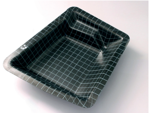
Komplexe Tape-Drapiergeometrie auf Basis von Polyphenylensulfid (PPS/CF)
