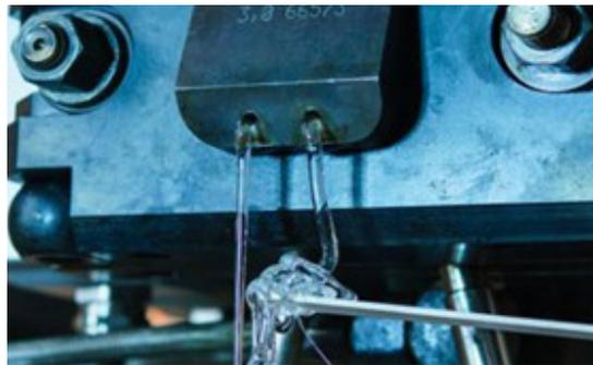
*Extrudierter Strang aus kontinuierlicher Synthese von thermoplastischem Polyurethan auf der Basis des neuen Paraformaldehyd-basierten Polyols, eine erneuerbare Alternative zum Erdöl.*
