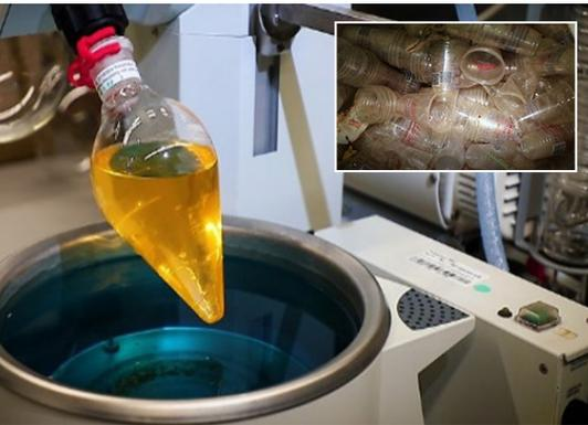
*Optimiertes Recycling von PLA am Beispiel von post consumer PLA-Abfällen eines öffentlichen Festes über die energiesparende Aufbereitung mittels Alkoholyse zur hochwertigen Wiederverwertung.*
