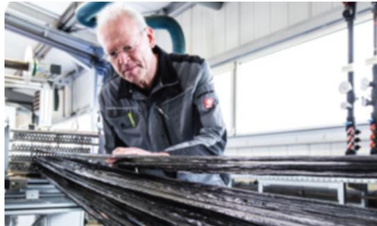
*Langjährige Erfahrungen auf dem Gebiet der Pultrusion ermöglichen, neue Wege zu gehen: Konzept- und Prozessentwicklungen im reaktiven thermoplastischen Pultrusionsverfahren zur Herstellung endlosfaserverstärkter, thermoplastischer Profile (z.B.  $\epsilon$ -Caprolactam zu Polyamid 6).*
