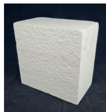
EPS-Dämmmaterial mit aufgereinigtem ehemals HBCD belastetem EPS
