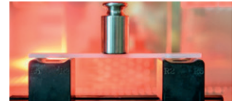
Temperaturbeständiger sc-PLA Prüfstab unter Belastung im Konvektionsofen
