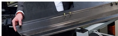
Metall-Kunststoff-Verbindung mittels nanoporöser Haftschrift
