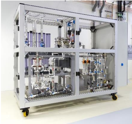
Bild 1: Demonstrator zur Herstellung von Ethen aus CO 2 . (© Fraunhofer IGB)
