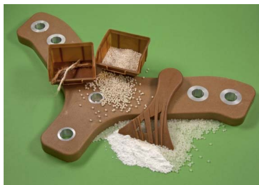
Foto Fraunhofer ICT Erfahrene Forscherinnen und Forscher am Fraunhofer ICT entwickeln Rezepturen auf Basis von PLA, PHB, TPS oder PBS zur Herstellung von spritzgegossenen Bauteilen für den Einsatz in technischen Anwendungen.
