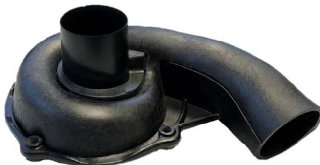
Bild Fraunhofer ICT Verdichtergehäuse in dreiteiliger Kunststoffbauweise bestehend aus Nasspress- und Spritzgießbauteilen
