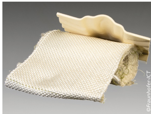
Selbstverstärktes PLA-Gewebe und daraus hergestelltes thermogeformtes Sandwichbauteil.
