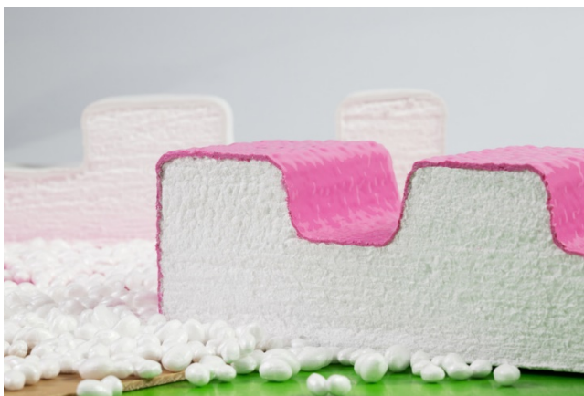
Fraunhofer ICT: Partikelschaum mit thermogeformter Deckschicht aus dem Projekt BioFLIP
