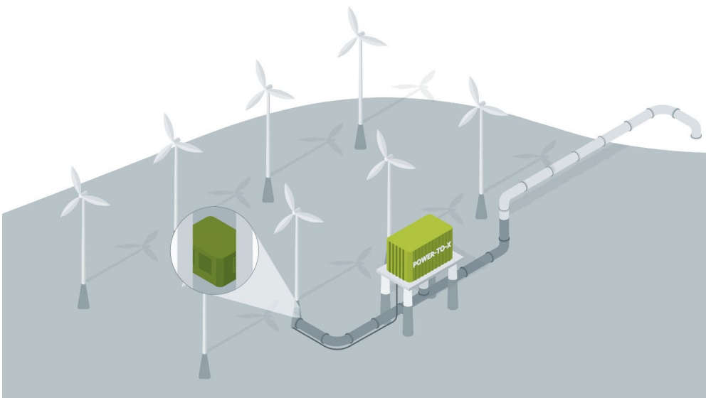
Schematische Darstellung der Erzeugung von Grünem Wasserstoff auf See im Projekt H 2 Mare. Grafik: Projektträger Jülich im Auftrag des BMBF
