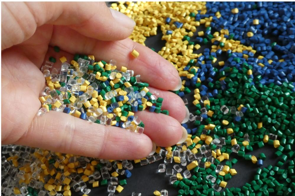
Bunte Mischung aus Kunststoffgranulaten: Für Sortier- und Recyclingtechnologien ist ein bunter Materialmix problematisch. © Fraunhofer UMSICHT
