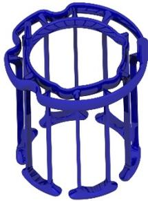
**Abb. 2** Kühlwasserkreislauf im Stator.
