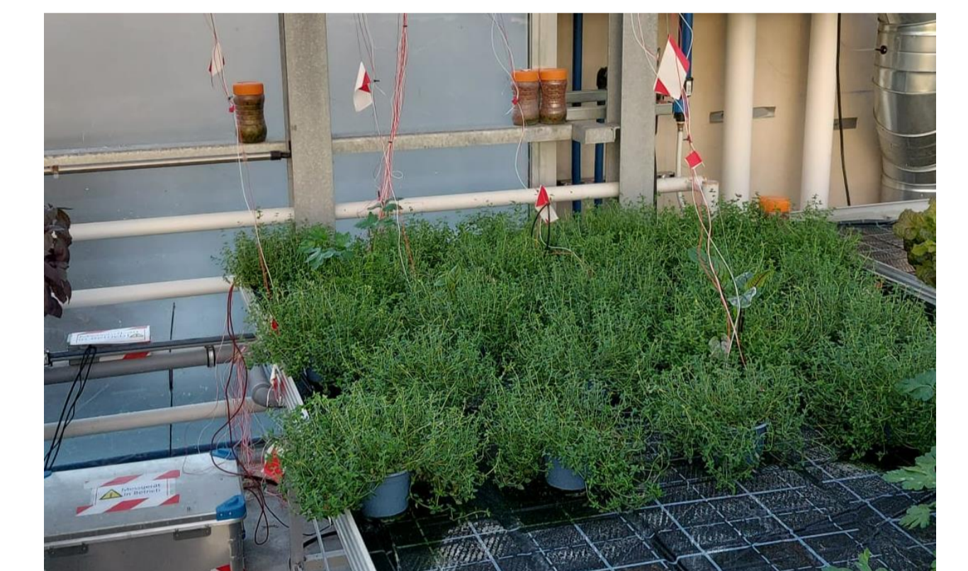
Messaufbau zur detaillierten Temperaturerfassung im Altmarkgarten in Oberhausen.
