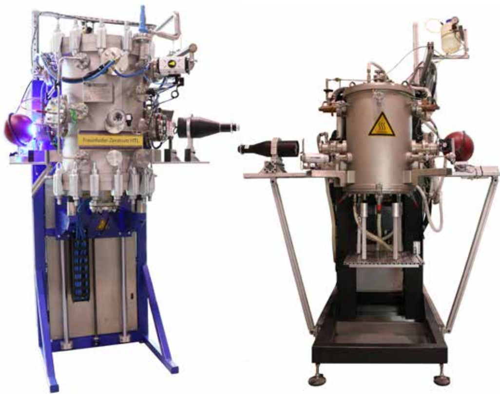
ThermoOptische Messanlagen (TOM) zur in-situ-Untersuchung des Einflusses von Wasserstoff und der Wasserstoffverbrennungsatmosphäre auf das Brenngut und die Ofenkomponenten
