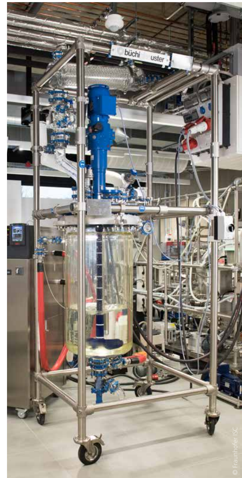
100 Liter-Synthesereaktor für die Hochskalierung von Katalysatormaterialien in den industriellen Technikumsmaßstab am Fraunhofer ISC, gekoppelt mit verschiedenen in-line-Analysetechnologien
