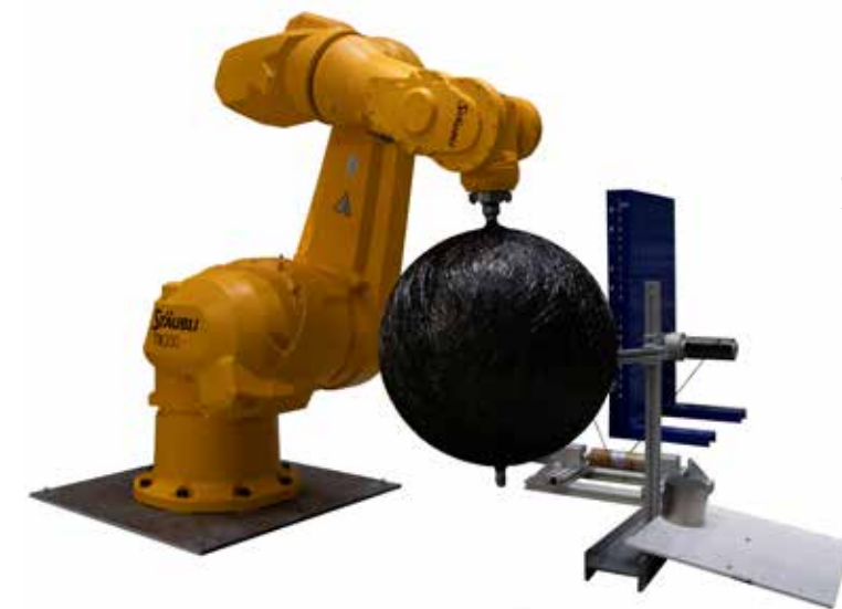
Herstellung eines isotensoiden Kugeltanks im KuWaTa-Projekt
