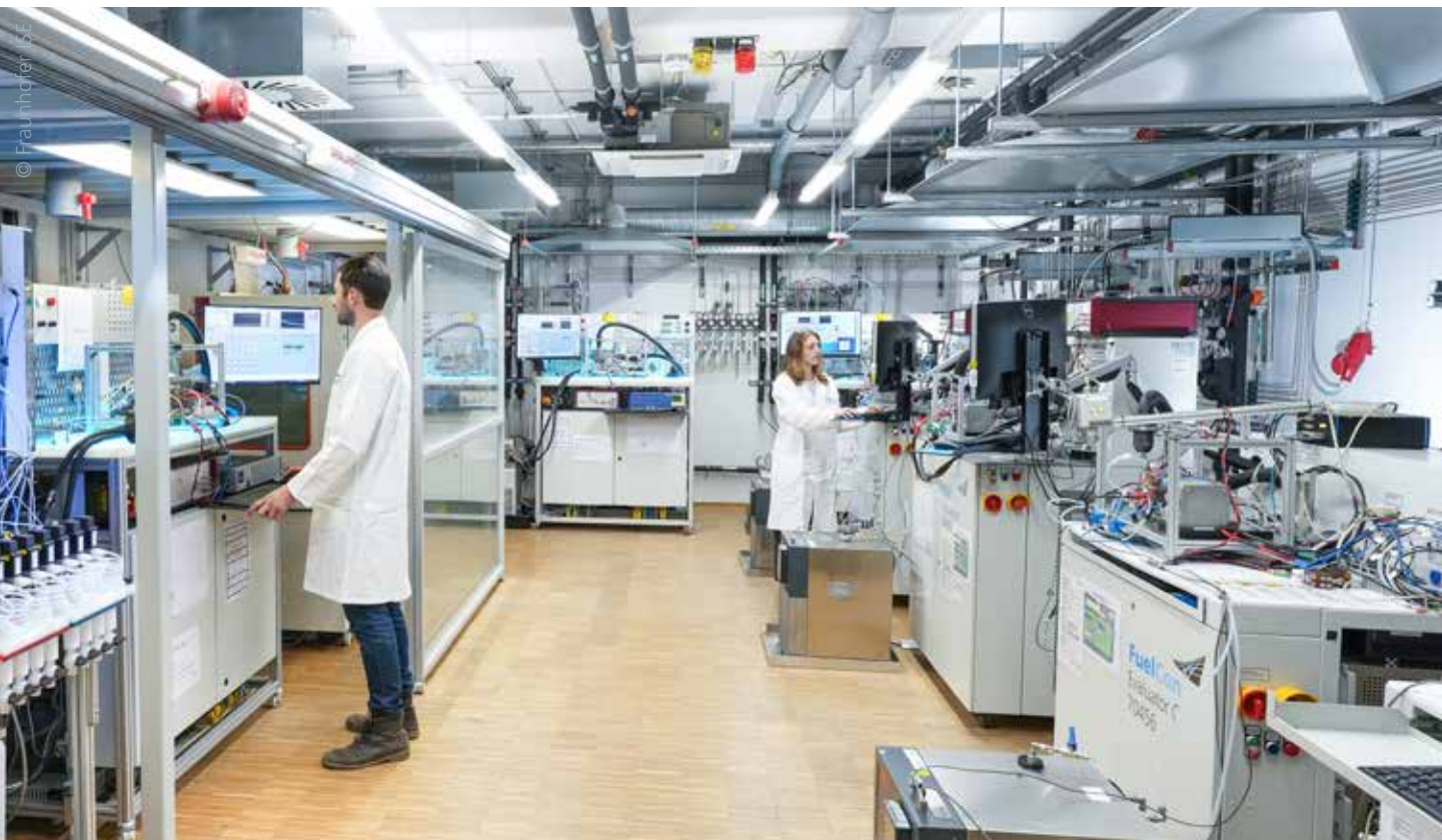
Teststände zur elektrochemischen Charakterisierung von Membranelektrodenheiten für PEM-Brennstoffzellen am Fraunhofer ISE.
