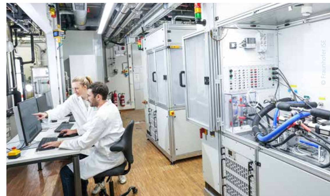
Teststände zur Charakterisierung von Brennstoffzellen-Kurztapeln für die Mobilität am Fraunhofer ISE.
