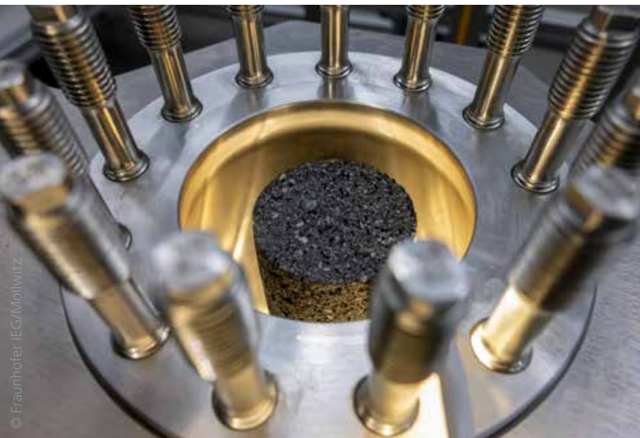
Poröse Gesteinsprobe eingebracht in den H 2 -Autoklaven des Fraunhofer IEG für Versuche unter Drücken von bis zu 50 MPa und Temperaturen von bis 200°C zur experimentellen Untersuchung von Gesteins-Fluid Wechselwirkung in potentiellen Speicherhorizonten für Wasserstoff.
