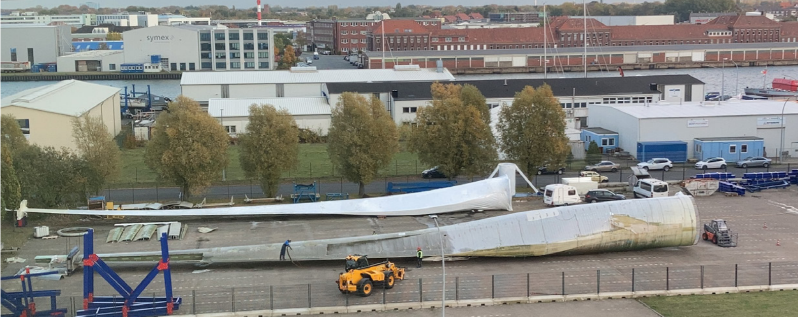
80 m langes Rotorblatt während der ersten Segmentierung © Fraunhofer IWES
