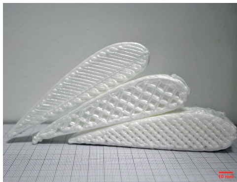
Flügelprofilquerschnitte mit unterschiedlichem Infill mittels Schaum-3D-Druck gefertigt.
