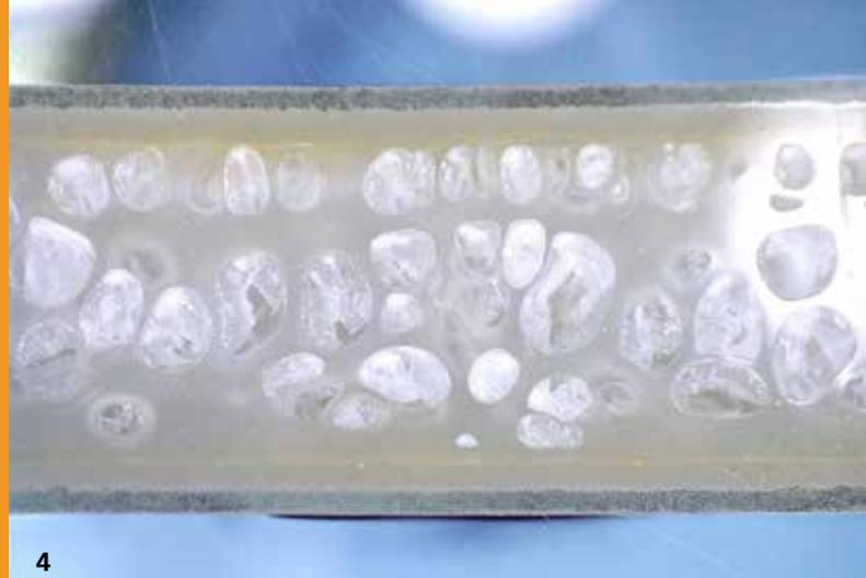
Dazu ist eine entsprechende Gasdosierstation notwendig, die größere Gasmengen im Polymer lösen kann. Außerdem fallen hier keine Zersetzungsrückstände an.
