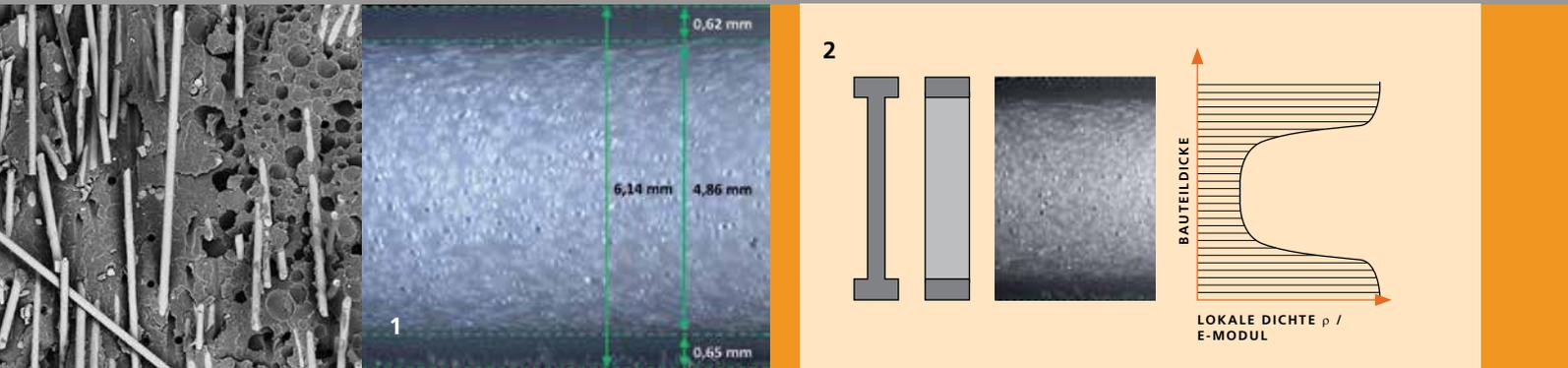
1 REM-Aufnahme eines mikrozellularen Integralschaums (PP/LGF30) (links) und Schliffbild eines feinzelligen Integralschaums (HMS-PP) (rechts).
