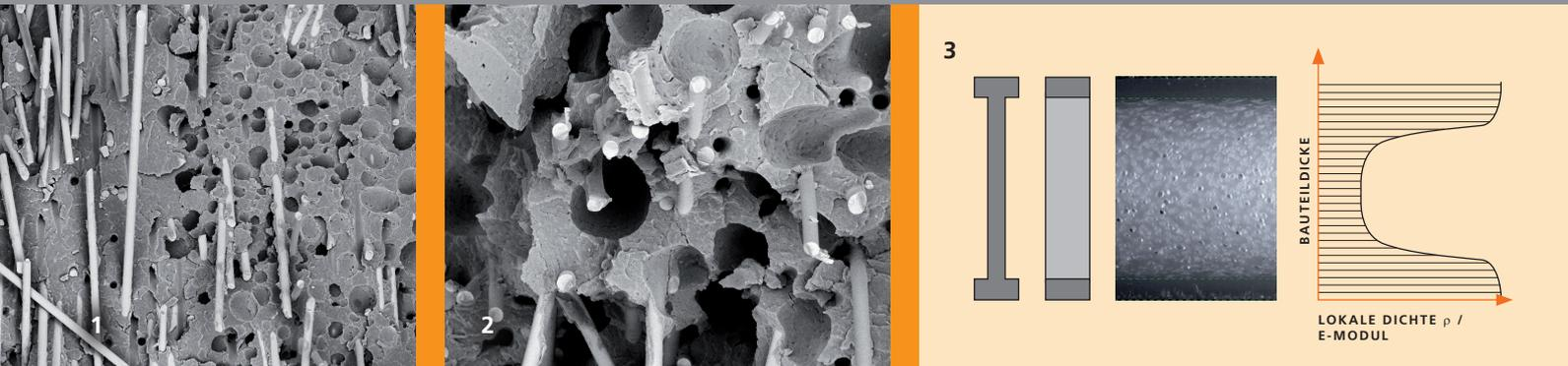
1+2 REM-Aufnahmen eines mikrozellularen Integralschaums (PP/LGF30).
