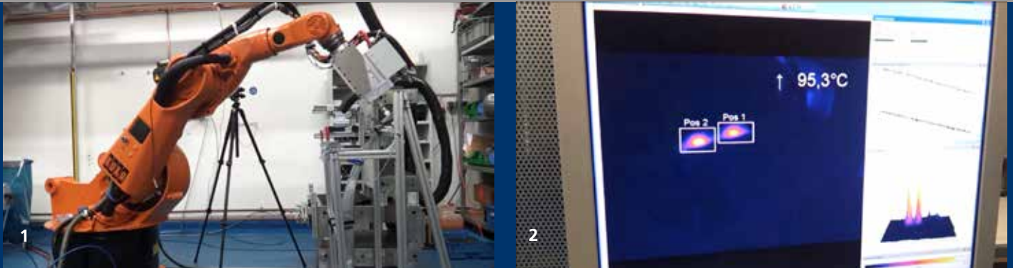
1 Anlage zur beschleunigten Aushärtung mit Mikrowellen (robotergestützt).
