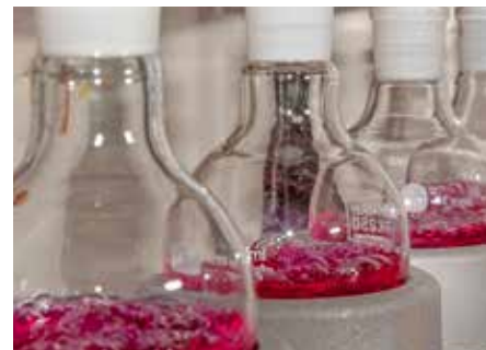
Oben: Dynamisch-mechanische Analyse (DMA) unter Zugbeanspruchung. Unten: Reiheextraktion zum Beispiel zur Restmonomerbestimmung.
