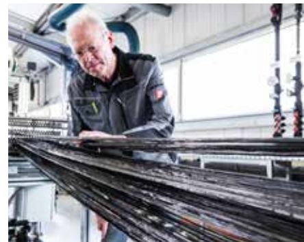
Oben: Leichtbaudemonstrator Fahrzeugunterboden. Unten: Kohlenstoff-Faser-Rovings, ca. 80 Rovings auf ihrem Weg zum Tränkbügel.
