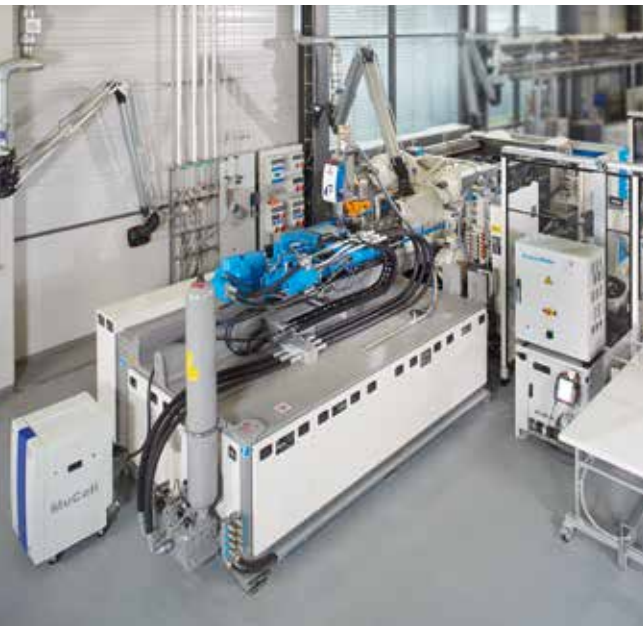
Spritzgießfertigungszelle zur Verarbeitung von rieselfähigen, duromeren Materialien und thermoplastischen Spritzgießgranulaten (links) und Fiberforge-Anlage zur voll automatisierten Verarbeitung von unidirektional faserverstärkten Thermoplast-Tapes (UD-Tapes) (rechts).
