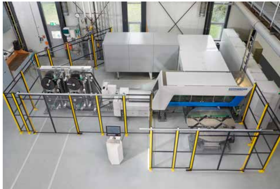
Spritzgießfertigungszelle zur Verarbeitung von rieselfähigen, duromeren Materialien und thermoplastischen Spritzgießgranulaten (links) und Fiberforge-Anlage zur voll automatisierten Verarbeitung von unidirektional faserverstärkten Thermoplast-Tapes (UD-Tapes) (rechts).
