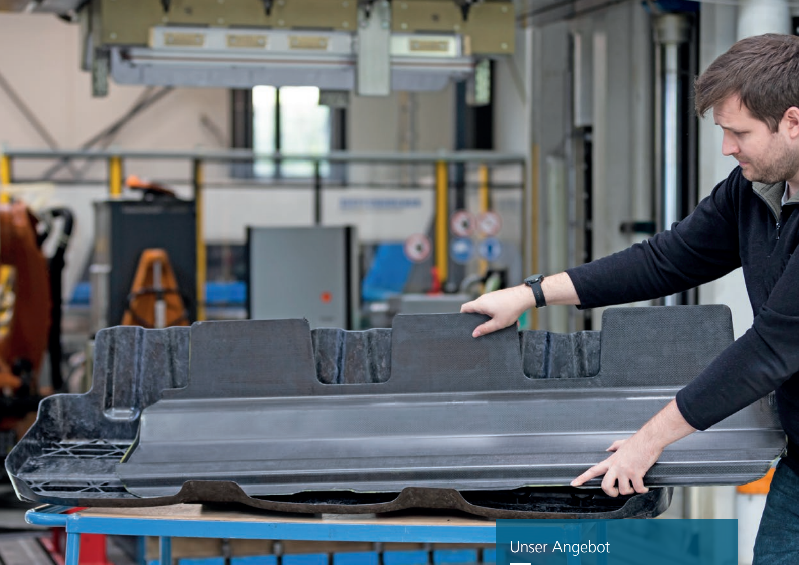
Sitzschale aus kohlenstofffaserverstärktem SMC für Verkehrsflugzeuge.
