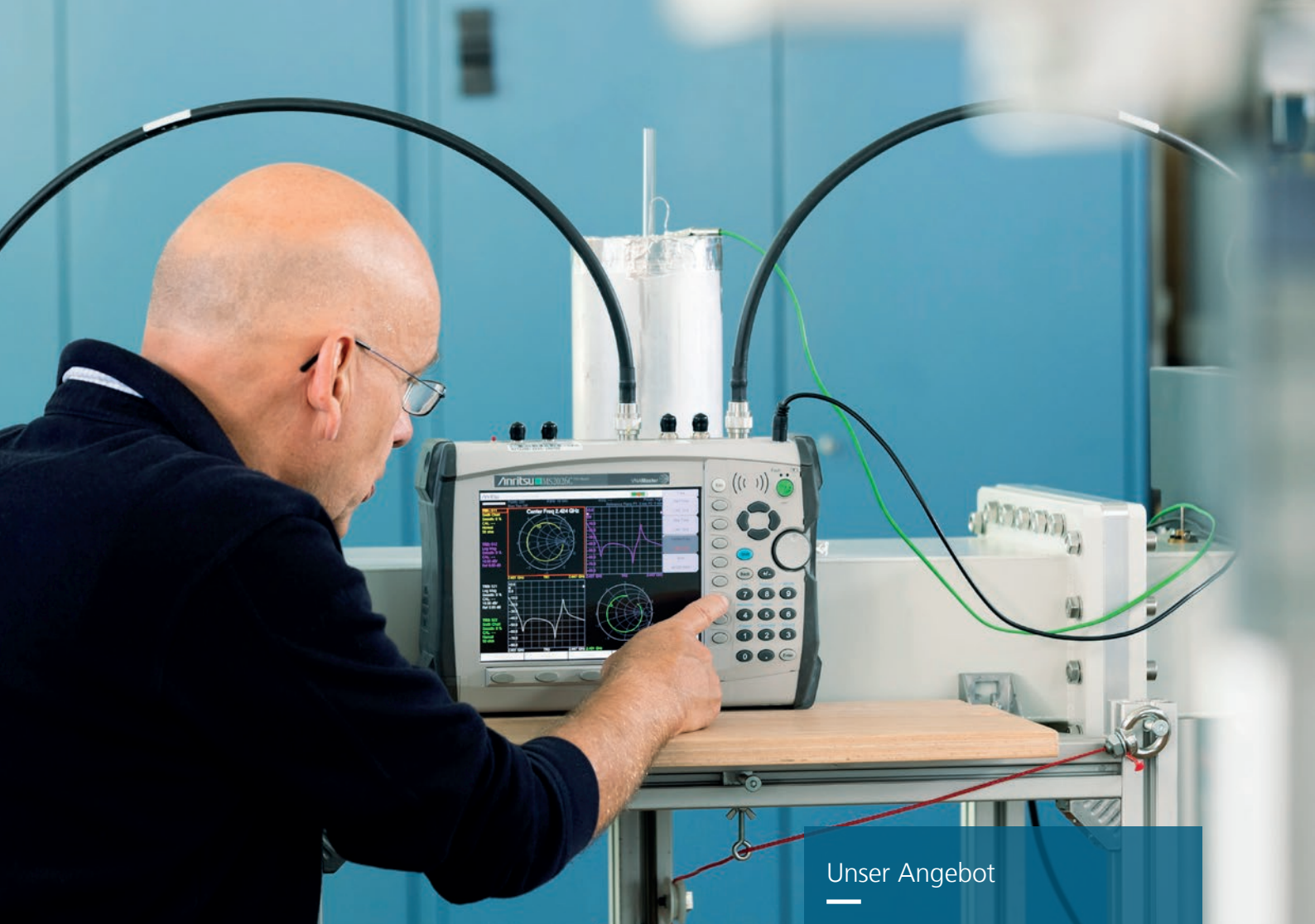
Apparatur zur Messung der Permittivität von Materialien.
