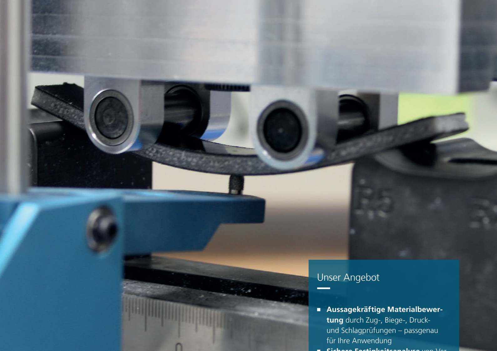
4-Punkt-Biegeprüfung eines Schaumsandwich-Bauteils.
