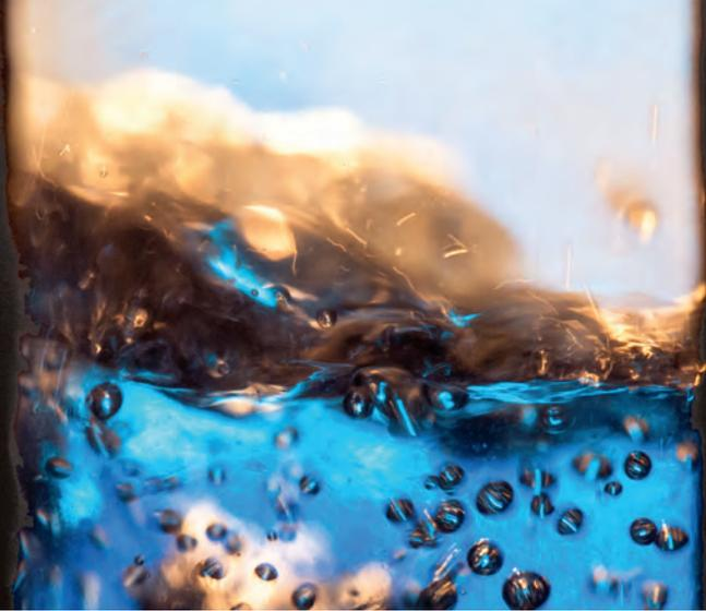
*Blick in eine Hochdruck-Zelle bei der CO<sub>2</sub>-Extraktion.*
