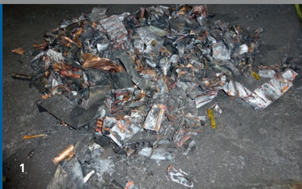
1 Zellüberreste nach einem Sicherheitstest an einem Batteriepack aus 18650-Zellen.
