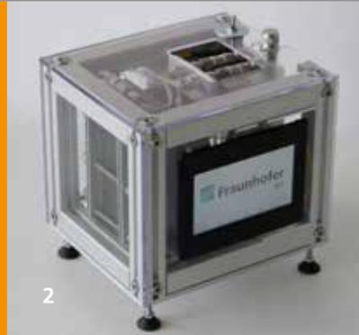
1 AEM-DAFC Kurzstapel mit ultraleichten Endplatten.
