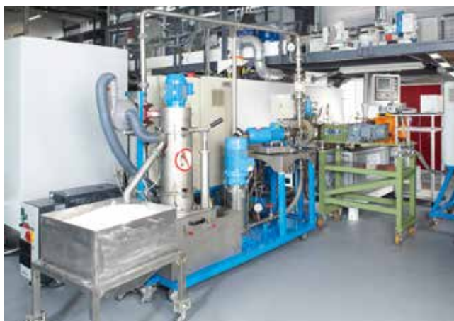
Bild 2. Blick in die Extrusionslinie: Während der Her- stellung treibmittel- geladener Granulate galt es, die Qualität über Wasserdruck, Temperatur und Treibmittelgehalt möglichst optimal einzustellen
