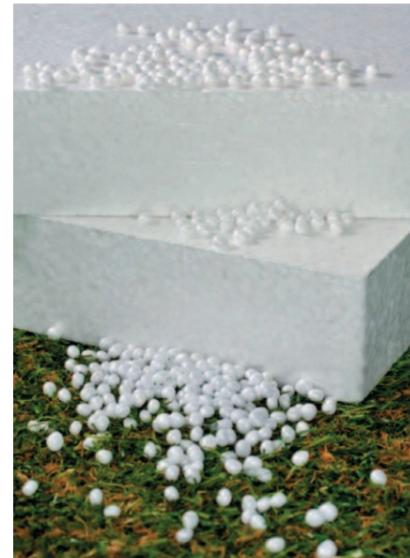
Abb. 5: Partikelschäume aus cellulosebasierten Biopolymeren
