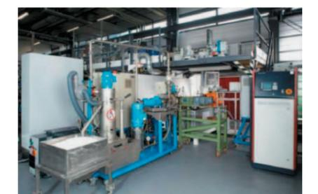
Abb. 3: Partikelschaumanlage mit anschließender Unterwassergranulierung
