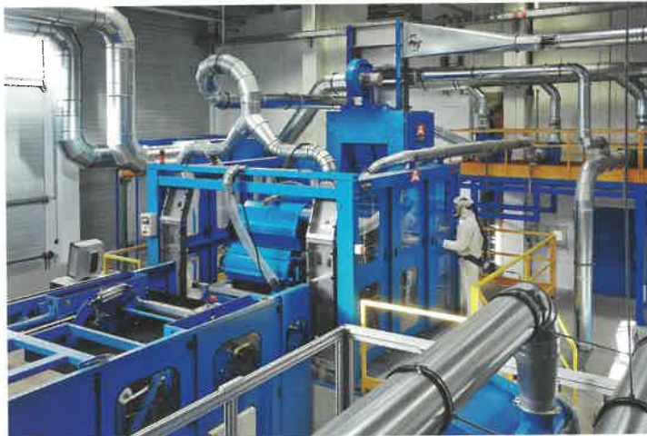
Abbildung 1: Mini-Card Krempel am STFI (oben) und Hochdruck RTM Prozess-technik bestehend aus Hydraulikpresse und Hochdruck-Injektionseinheit am Fraunhofer ICT (unten)
