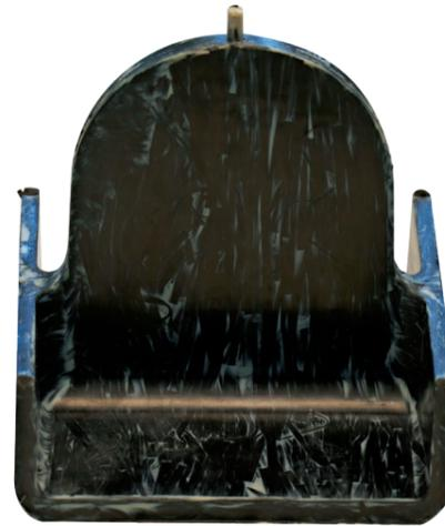
FVK-Geometrien im RTM hergestellt werden können. Das Halbzeug lässt sich wie übliche textile Halbzeuge zuschneiden und verarbeiten, ist jedoch sehr empfindlich bezüglich Scherbelastungen. Das Material ist stark gerichtet und die parallelen Stränge sind in Querrichtung nur schwach durch den Binder konsolidiert.
