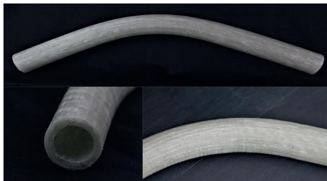
**Bild 2.** Mittels lokalem Streckbiegen umgeformtes Hohlprofil © Fraunhofer ICT
