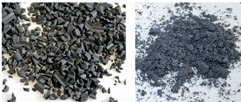
Bild 1. Stützchnüre aus Produktionsabfällen (links) und zerleinerte Angüsse von Waschmaschinenichtungen werden der Produktion von Neuware als Füllstoffe wieder zugeführt.
