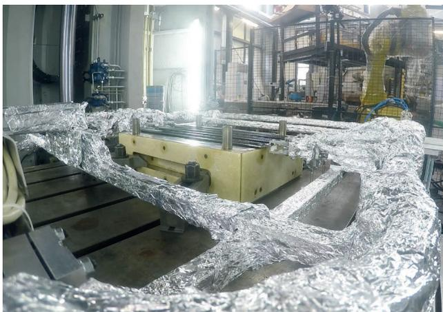
**Bild 3.** Der greiferassistierte Umformprozess verhindert, dass das Organoblech zu früh oder unkontrolliert mit dem Umformwerkzeug in Kontakt kommt (© Fraunhofer ICT)
