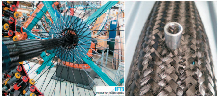
Abb. 5: Flechtmaschine (links), Flechtrohling mit eingeflochtenem Insert (rechts)
