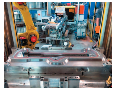
Abb. 6: Eingelegter Flechtrohling im Hochdruck-RTM-Werkzeug
