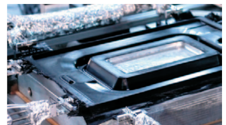
Abb.3: Aufheizung im IR-Feld, Transport des Geleges zum Werkzeug und Entformen des umgeformten Bauteils
