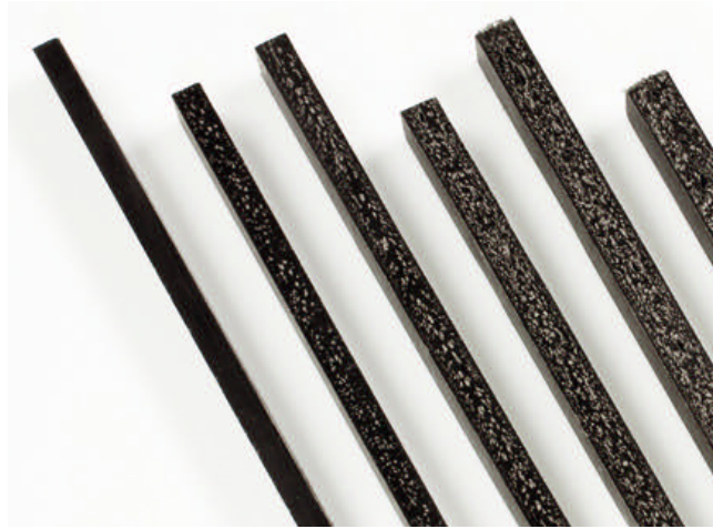
Bild 2. Alle LFT-D-Schaum-Prüfkörper besitzen die gleiche Masse wie das kompakte Referenzbauteil (links). Von links nach rechts nimmt die Wanddicke bzw. Dichtereduktion zu
