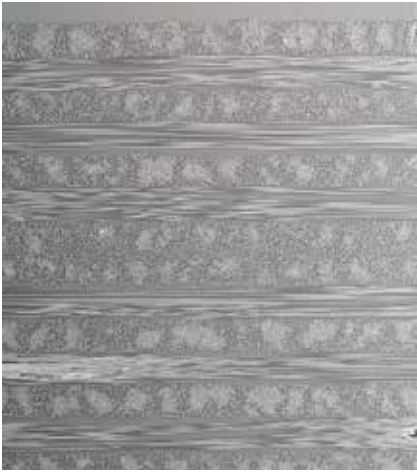
Bild 2. Mit einem Rasterelektronenmikroskop (REM) aufgenommene Schlißbilder von konsolidierten Gelegen (Kreuzlaminat) mit niedrigem (links) und hohem Porengehalt (rechts). Die Poren sind hier als schwarze und weiße Bereiche zu erkennen (© Fraunhofer ICT)
