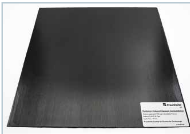
Bild 3. Das strahlungsinduzierte Vakuumkonsolidieren (SVK) schützt das Material vor thermoxidativem Abbau (Quelle: Fraunhofer ICT)
