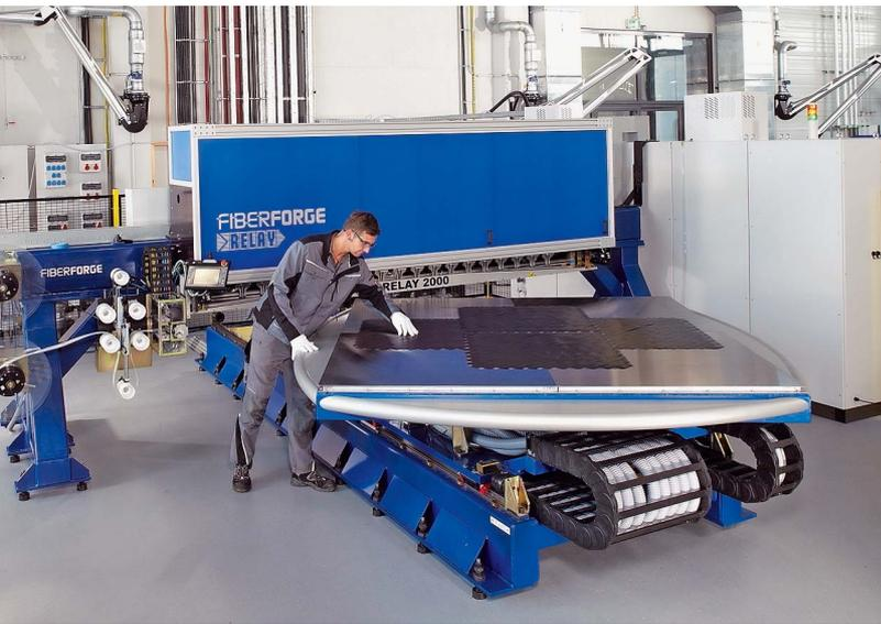
Mit der Anlage Fiberforge-Relay 2000 lassen sich UD-Tapes schichtweise zum anwendungsspezifischen Gelege platzieren. Durch den hohen Durchsatz eignet sich das Verfahren für mittlere und große Serien
