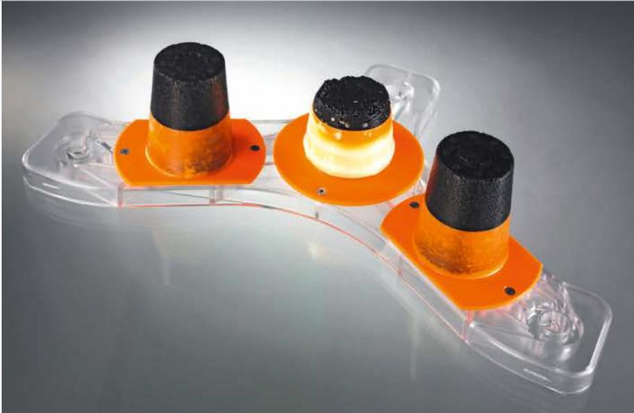
**Bild 4.** Der Crashdemonstrator besteht aus partikulärem, mit einer spritzgegossenen Halbkapselung verbundenem EPP-APM-Hybridschaum
