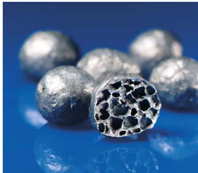
Bild 2. Die geschäumten Aluminiumpartikel (APM) werden mit Polyschaum umhüllt
