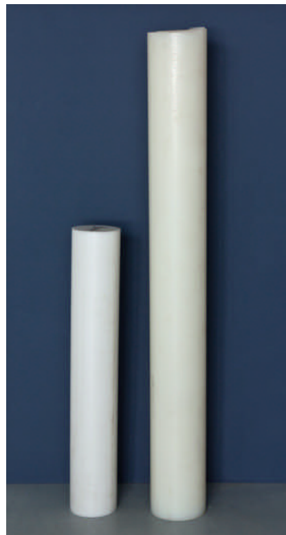
Bild 1. Untersuchte Halbzeuge aus den Materialien Polyamid und Polyoxymethylen
