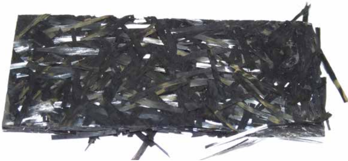
Kohlenstoff- fasergerüst einer mit Mikrowellen pyrolysierten CFK-Platte
