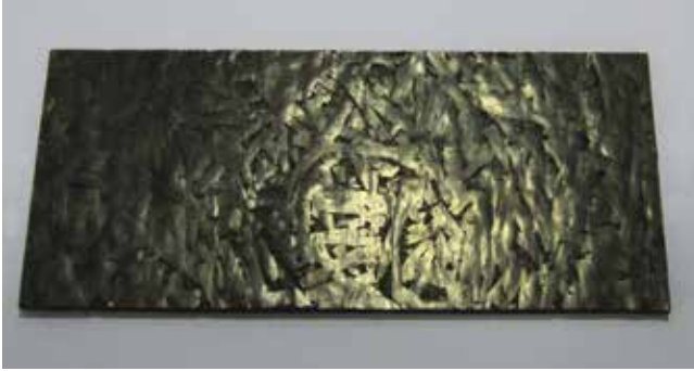
Bild 2. Langfaserverstärkte CFK-Platte mit UP-Matrix (vor der Pyrolyse)
