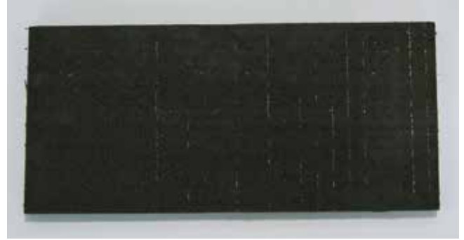
Bild 3. Endlosfaserverstärkte CFK-Platte aus Prepregs (vor der Pyrolyse)
