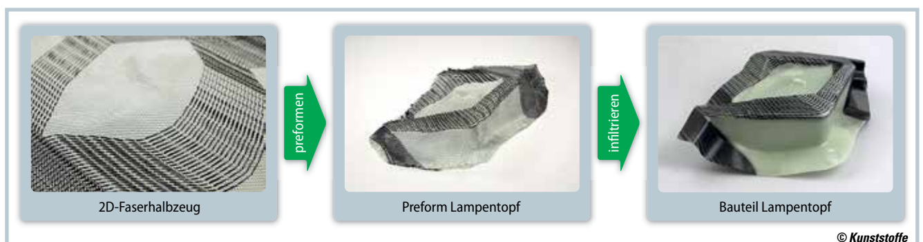
Bild 5. Schritte der Weiterverarbeitung eines mit der ORW-Technik multiaxial verstärkten Gewebes zum fertigen Faserverbundbauteil: zweidimensionaler Faserzuschnitt (links), Faserpreform (Mitte), infiltriertes RTM-Bauteil (rechts) (Quelle: Fraunhofer ICT)
