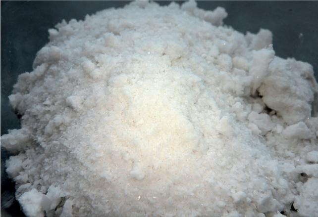
**Bild 4.** Rezyklierter Bishydroxyethylterephthalat aus der PET-Misch
