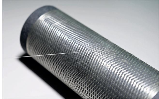
**Bild 2.** Hergestelltes Multifilamentgarn aus 100 % recykliertem PP.
