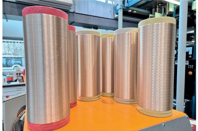
**Bild 5.** Hergestelltes Multifilamentgarn aus 100 % rezyklierten PET.
