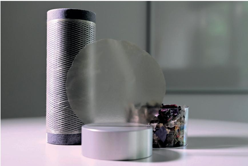
Von Mischkunststoffabfall zur PP-Rezyklatfolie und PP-Multifilamentgarn.
