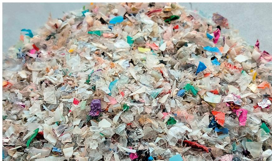
**Bild 3.** Zerkleinerte Post-Consumer-PET-Misch Fraktion. © Fraunhofer ICT
