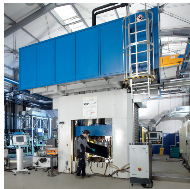
Schaumtandex-Extrusionsanlage (links) und Hochdruck RTM Prozesstechnik bestehend aus Hydraulikpresse und Hochdruck-Injektionseinheit zur Herstellung von Hochleistungsfaserverbunden (rechts).
