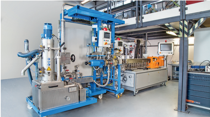
Partikelschaumlinie zur kontinuierlichen Herstellung von Partikelschäumen.
