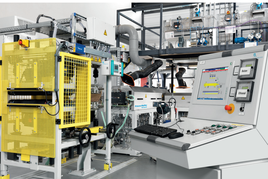
Schaumtandex-Extrusionsanlage (links) und Hochdruck RTM Prozesstechnik bestehend aus Hydraulikpresse und Hochdruck-Injektionseinheit zur Herstellung von Hochleistungsfaserverbunden (rechts).
