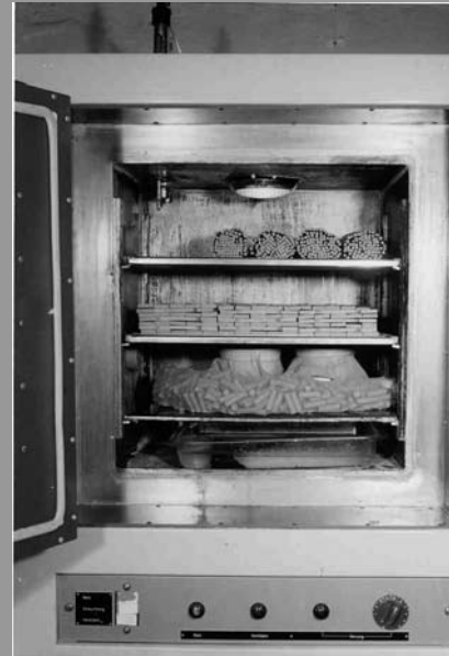
Lagerung- und Lebensdauer testing von Treibsätzen
